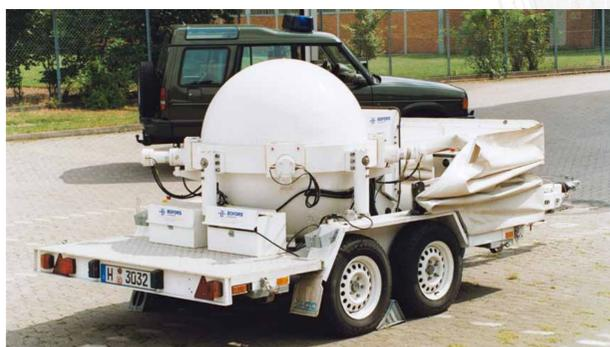
Bombentransportbehälter mit Zugfahrzeug
