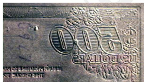
Prägung der Scheckrückseite zur Imitation eines hochwertigen Druckverfahrens (Stichtiefdruck)
