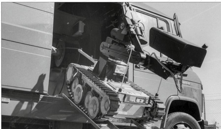
Entschärfungsroboter Römi II im Einsatz (Foto: Rainer Dröse)
